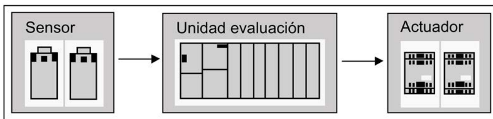
Figura 4-2 Cadena de procesamiento: captura, procesamiento, emisión
