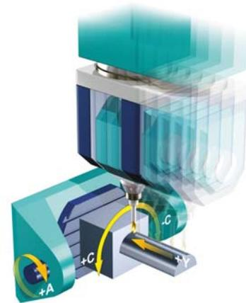
Für einen Umlauf schwenkt der Tisch 90° um die A-Achse. Die C-Achse dreht jeweils um von +90° auf -90° und das Werkzeug verfährt in der Y-Achse.
