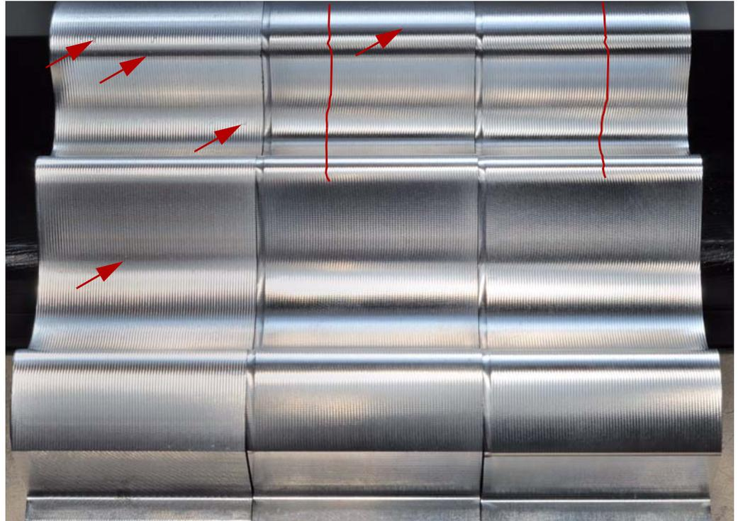
Die Fräsbahnen verlaufen sehr gleichmäßig. Einzig an engen Kurvenverläufen sind Druckstellen/matte Stellen aufgrund des drückende Schnitts des Kugelfräsers sichtbar. Diese werden dadurch verursacht, dass der Fräser nicht frei schneiden kann und das Material wegdrückt.
