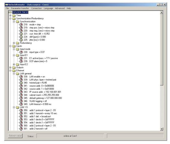
Figure 8-2 SICLOCK TM parameter menu
