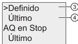
Las dos primeras filas muestran las opciones disponibles. La fila inferior muestra el ajuste actual de los canales de salida analógicos. El ajuste predeterminado es 'Último'.
