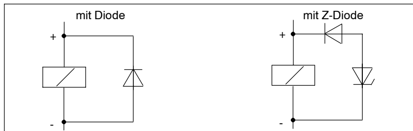
Bild A-9 Beschaltung von gleichstrombetätigten Spulen
