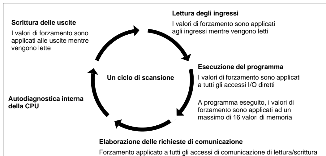
Figura 6-14 Ciclo di scansione della CPU S7-200
