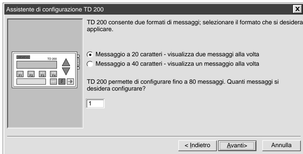
Figura 5-7 Formato e numero dei messaggi del TD-200
