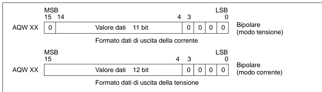
Figura A-39 Formato parola dati di uscita
