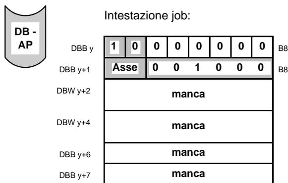
Con il job "tacitazione segnalazione errori WF per avanzamento", è possibile resettare le segnalazioni WF relative a questi errori. Per questo bisogna prestare attenzione perchè alcune segnalazioni di errore WF per avanzamento, possono essere resettate solo per mezzo del segnale di comando "resettare asse" [RST].
