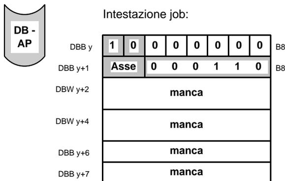
Se i dati macchina vengono trasmessi a un asse, questi dapprima approdano in una memoria intermedia. L'asse lavora ancora con il precedente blocco di dati macchina.
