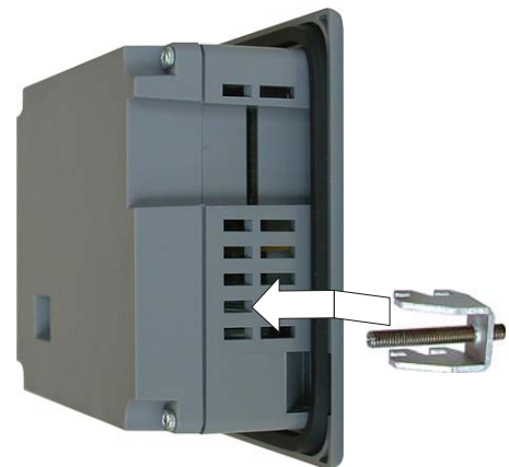
Esempio: installazione di un morsetto di metallo nel TP 177 4"
