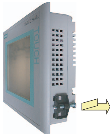
Esempio: installazione di un morsetto di plastica nel TP 177A
