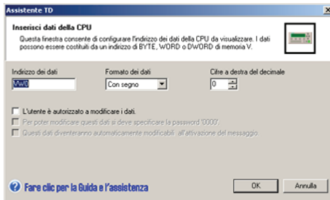
Figura 4-19 Inserimento dei dati del PLC
