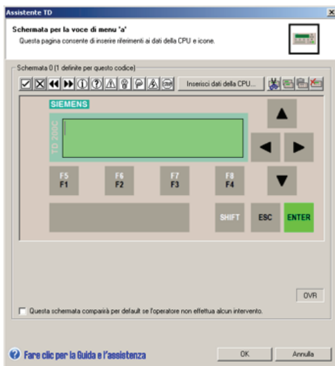
Figura 4-17 Creazione del messaggio per una schermata del TD 200C
