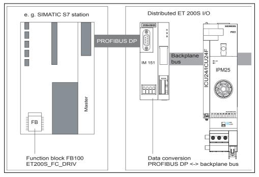
Fig. 4-2 PROFIBUS DP coupling for ET 200S
