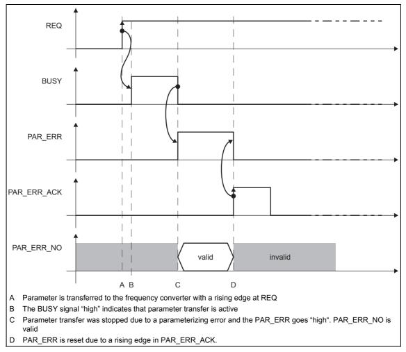
Fig. 5-6 Parameterizing error
