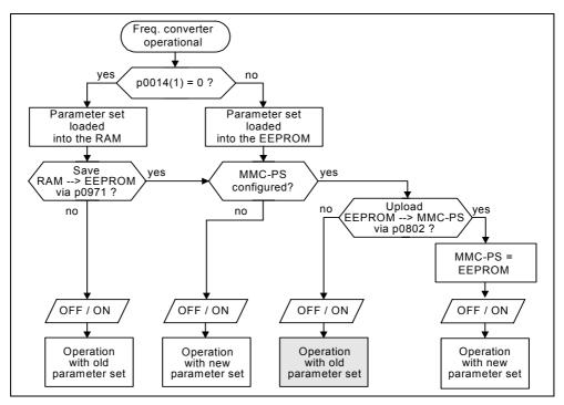
Bild 6-40 Changing parameters with STARTER
