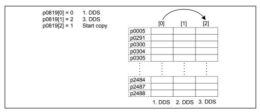
Fig. 6-10 Copying from DDS1 to DDS3
