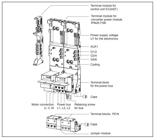
Fig. 2-1 Terminal modules for ET 200S FC
